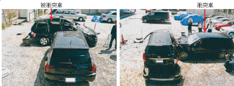
被衝突車の側部凹損量の測定状況図
