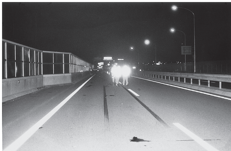
〈写真1.1 スリップ痕の印象状況（ABS非装着車両）〉
