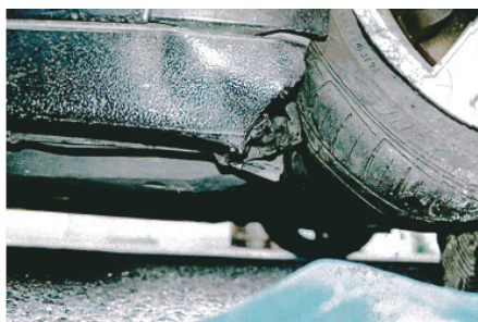
A車の右前部及び車底部周辺に路面と擦過した損傷は認められない
