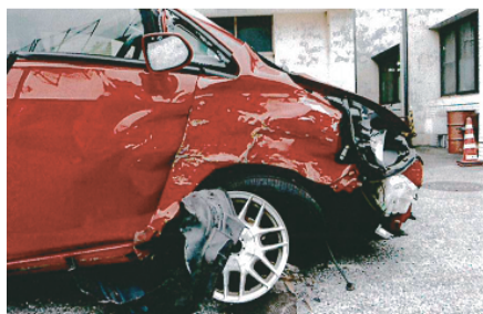
B車の右前部及び車底部周辺に路面と擦過した損傷が認められる
