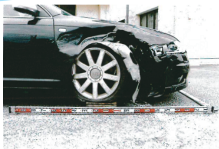
A車の右前部及び車底部周辺に路面と擦過した損傷は認められない
