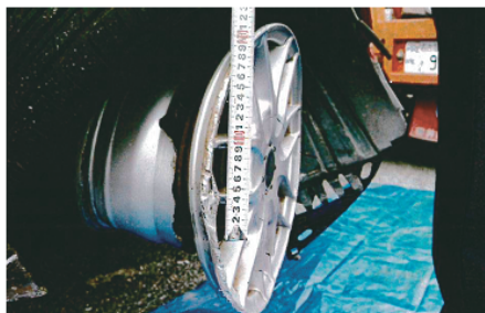
B車の右前部及び車底部周辺に路面と擦過した損傷が認められる
